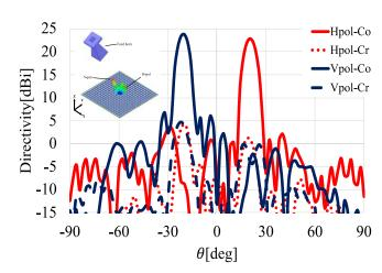
図 2 提案リフレクトアレーアンテナによる 放射パターン特性(シミュレーション)
