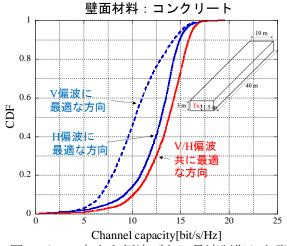
図1ビーム方向を偏波ごとに最適制御した際の チャネル容量特性 (シミュレーション)
