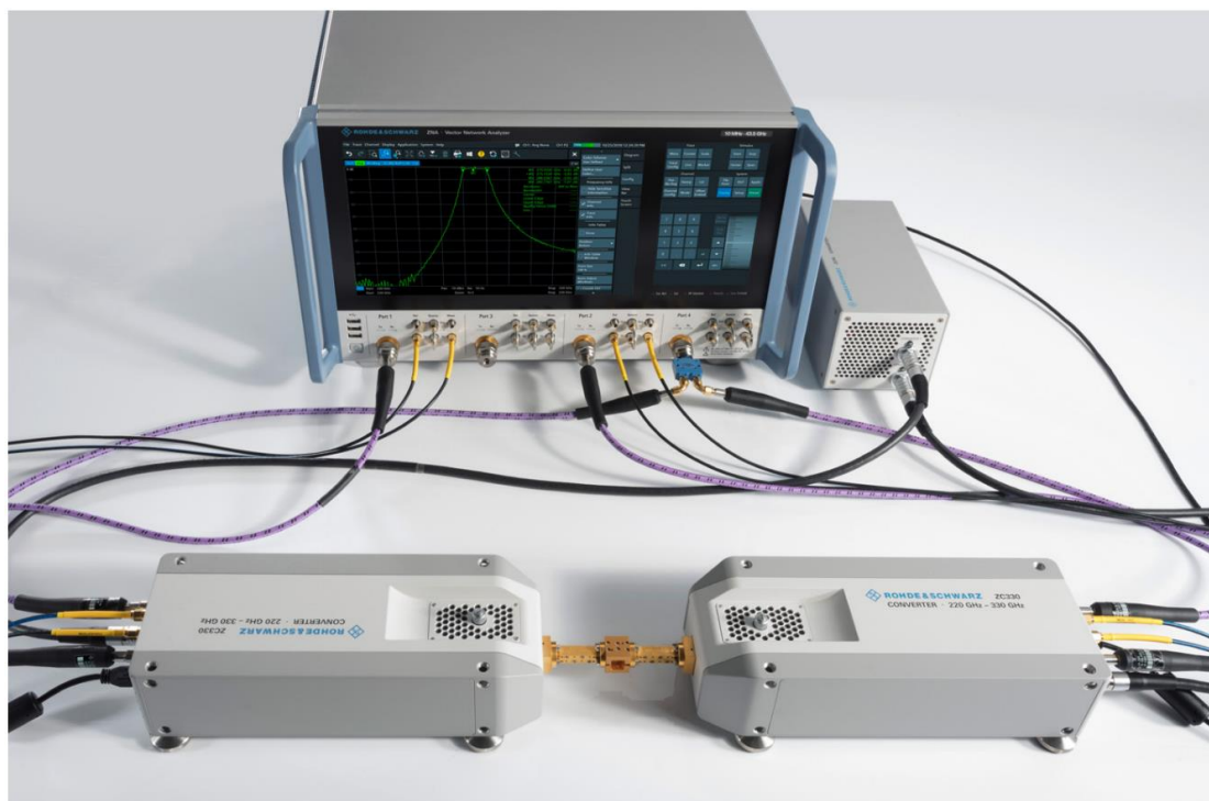
Fig. 1 ミリ波帯/サブテラヘルツ帯ネットワーク・アナライザの構成例
