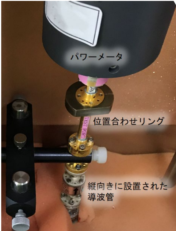
図7 導波管の接続例
