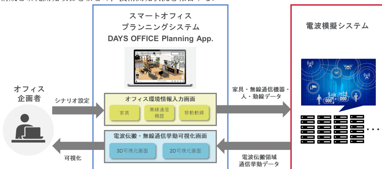
図1 スマートオフィスプランニングシステムと電波模擬システム連携構成
