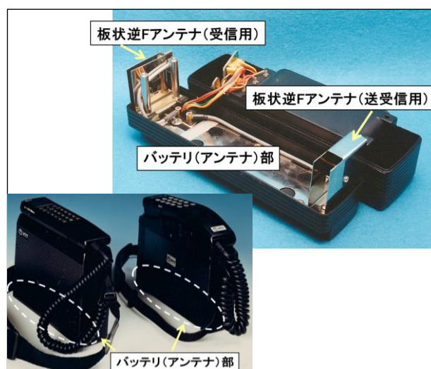
図B 逆Fアンテナの実装例(ショルダ－ホン)
