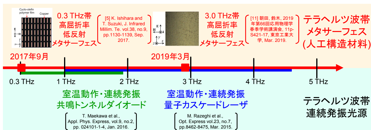
図1 テラヘルツ産業応用のためのメタサーフェスの進捗[11]
