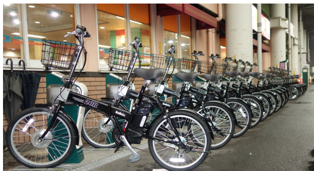
写真1. 世界初の電動アシスト自転車の完全無人化ワイヤレス給電
