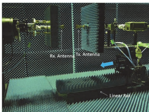
図 外挿法によるミリ波帯アンテナ利得の測定
