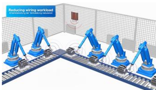
図 工場機器内のセンサへの電力伝送
