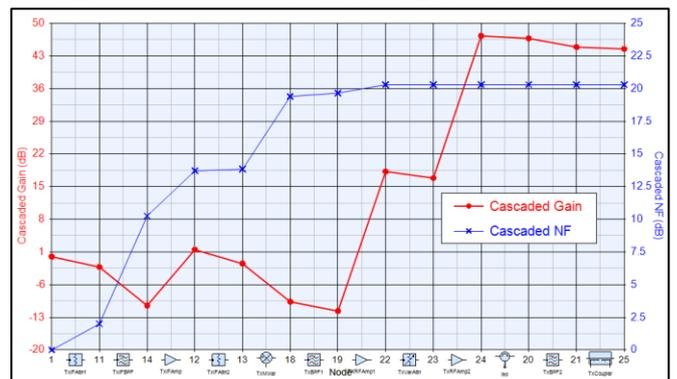
図3 送信機の Gain と NF のレベルダイアグラム
